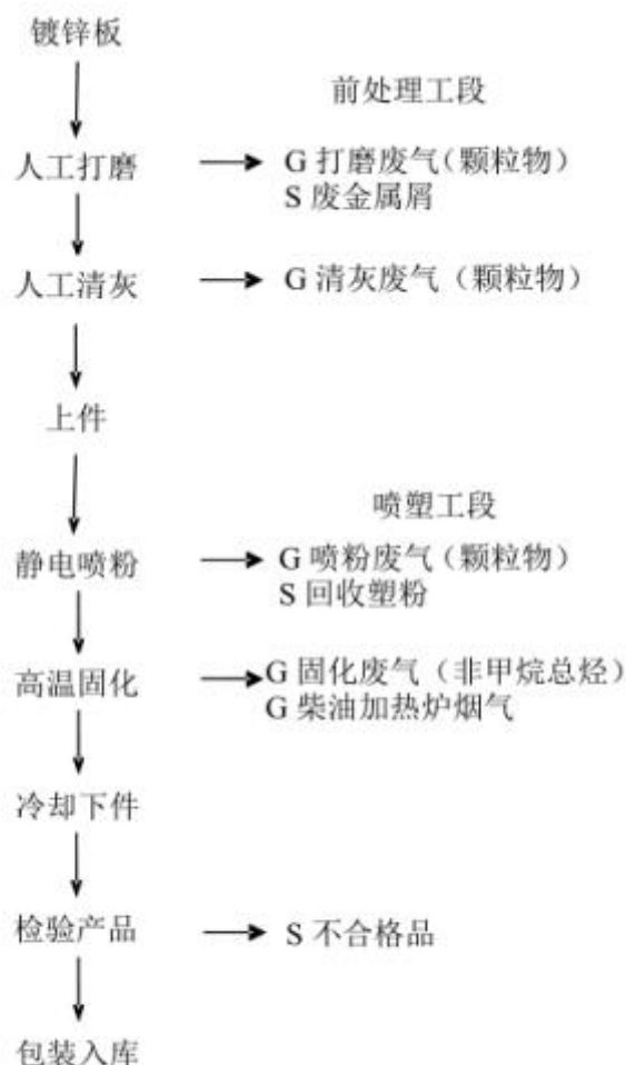
图 1 表面喷塑生产工艺流程图
